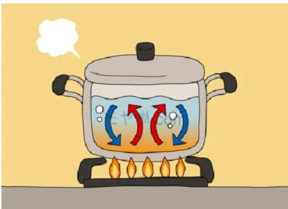
Рис. 1. Конвекционные потоки в жидкости
