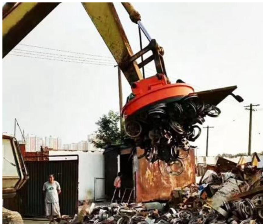
Рисунок 2. Электромагнит на свалке автомобильных деталей
